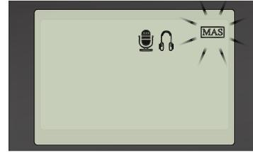
Presione el botón (+) o (-) para seleccionar SLV (esclavo) o MAS (maestro). NOTA: Cuando el icono de micrófono esté en uso se debe definir como Maestro, excepto cuando se usa el repetidor. El repetidor debe configurarse como Maestro.
